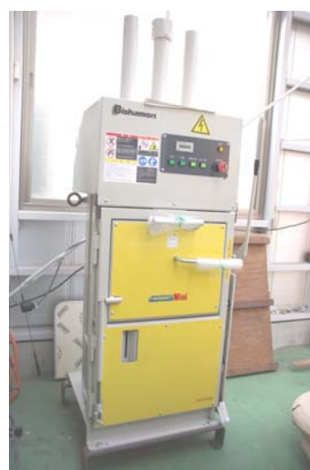
BISHAMON プレスキーミニ サーマルリサイクル利用する廃プラの運搬 を効率化する圧縮減容機
