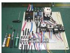
締付トルク技量者認定試験盤と試験の実施
